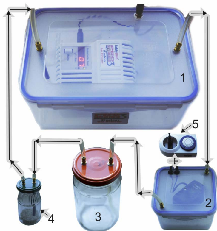
Рис. 1. Лабораторный стенд для исследований удельной активности радона в образцах проб. Здесь: 1 – рабочая камера измерительного блока; 2 – циркуляционная помпа; 3 – емкость для пробы и барботер; 4 – осушающий модуль; 5 – суточный таймер управления насосом.
