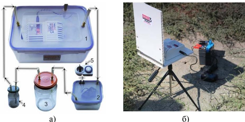
Рис. 9. Стенды радоновых исследований: а) лабораторный стенд для исследований удельной активности радона в образцах проб; б) стенд для проведения замеров радонового фона на месте проводимых исследований.
