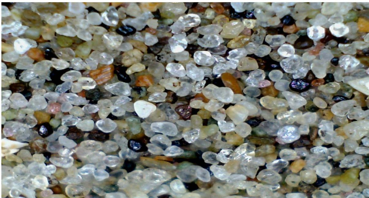
Рис. 6. Проба песка, содержащего включения монацита и флюоресцирующего ильменита, под микроскопом (50х) в отраженном свете.
