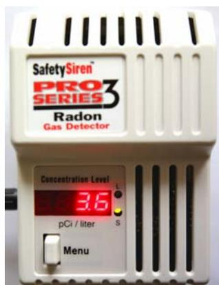
Рис. 10. Индикатор радона Pro Series3 Radon Gas Detector HS71512.
