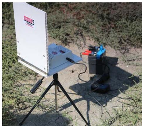
Рис. 11. Стенд для проведения замеров радонового фона на месте исследований.
