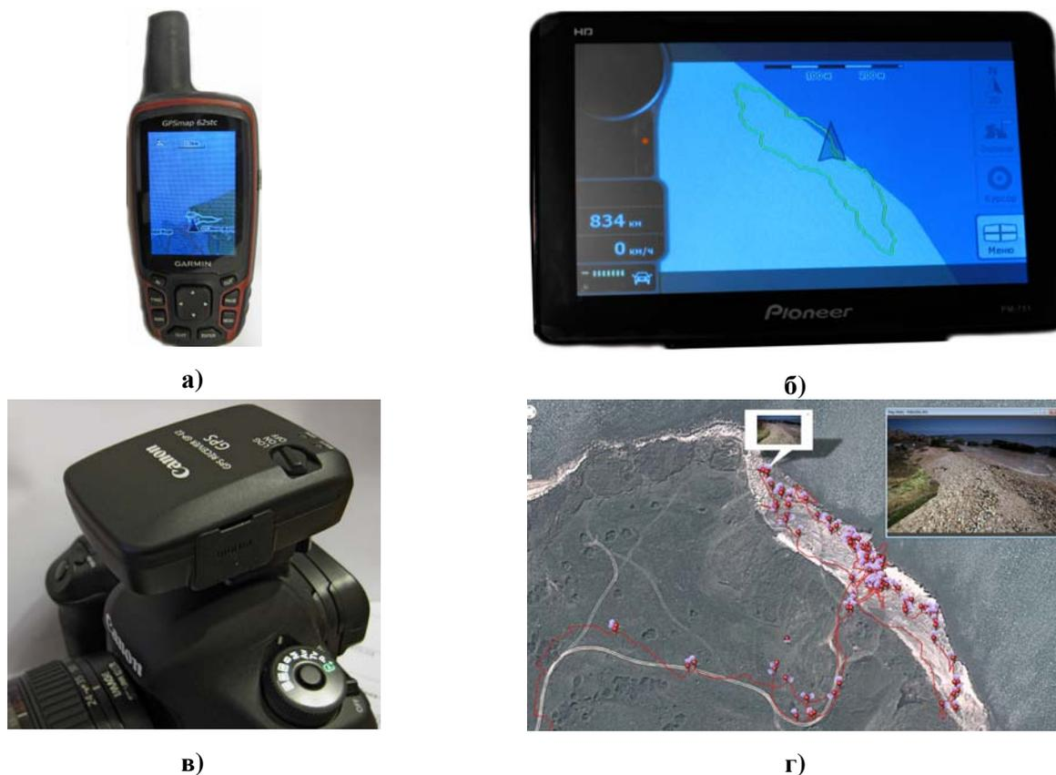
**Рис. 8. Навигационное оборудование, которое использовалось в 2013 году для проведения натурных исследований: а) Garmin 62 stc; б) Pioneer PM-751; в) GP-E2; г) пример фиксирования трека, точки и направления съемки с помощью навигатора GP-E2.**
